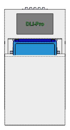
Um die Tastatur zu bedienen, wird die Klappe abgenommen, der Rechner herausgeschwenkt und die Klappe tiefer eingehängt. Dadurch bekommt die Tastatur eine feste Auflage.
